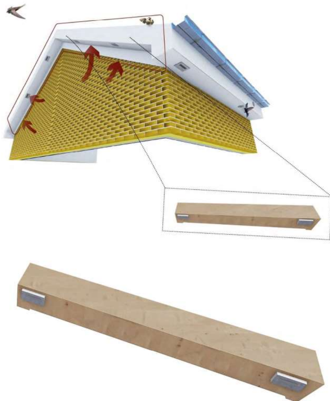
Figuur 4 De Vleermuiskast VML1 van Unitura. (...) Deze maatwerkinbouwkast kan o.a. ingebouwd worden in overstekken.
