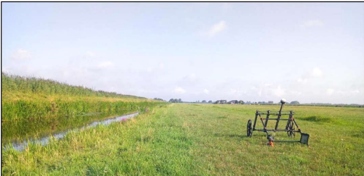
Afbeelding 2: De handkar met het Vallon multisondesysteem op de projectlocatie. (Bron: Euroradar)
