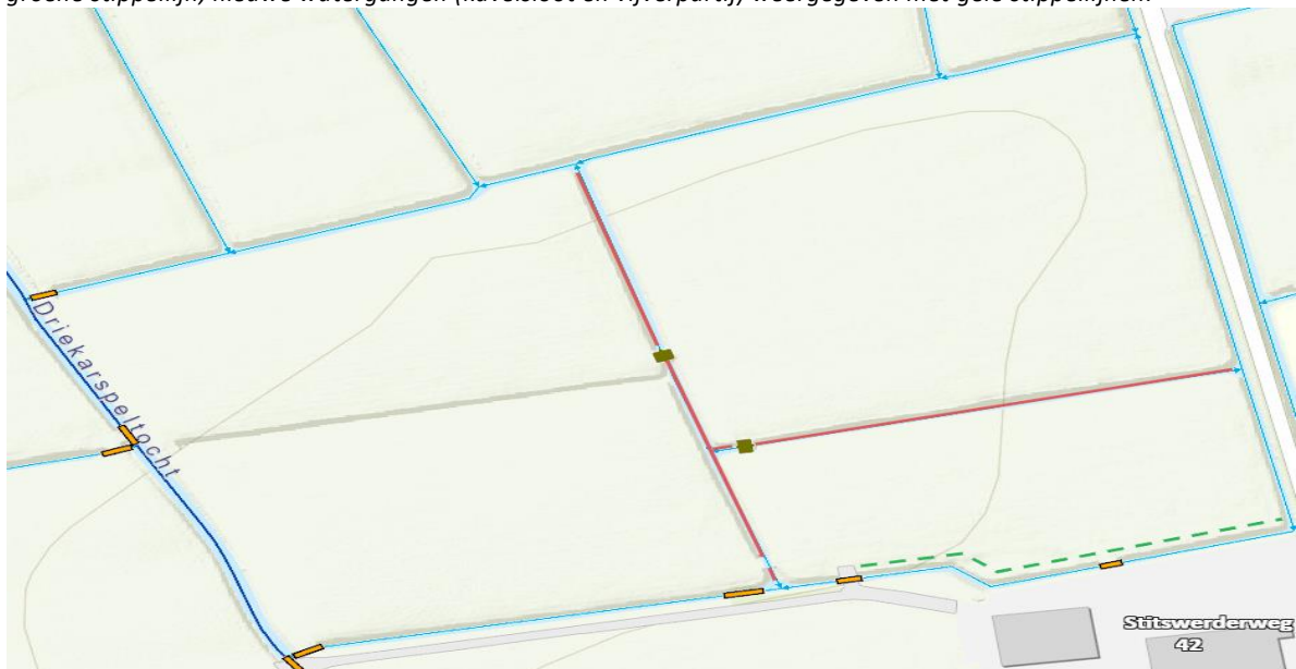
Figuur 2: Te dempen watergangen weergegeven met rode lijnen, te verbreden watergang weergegeven met groene stippellijn.
