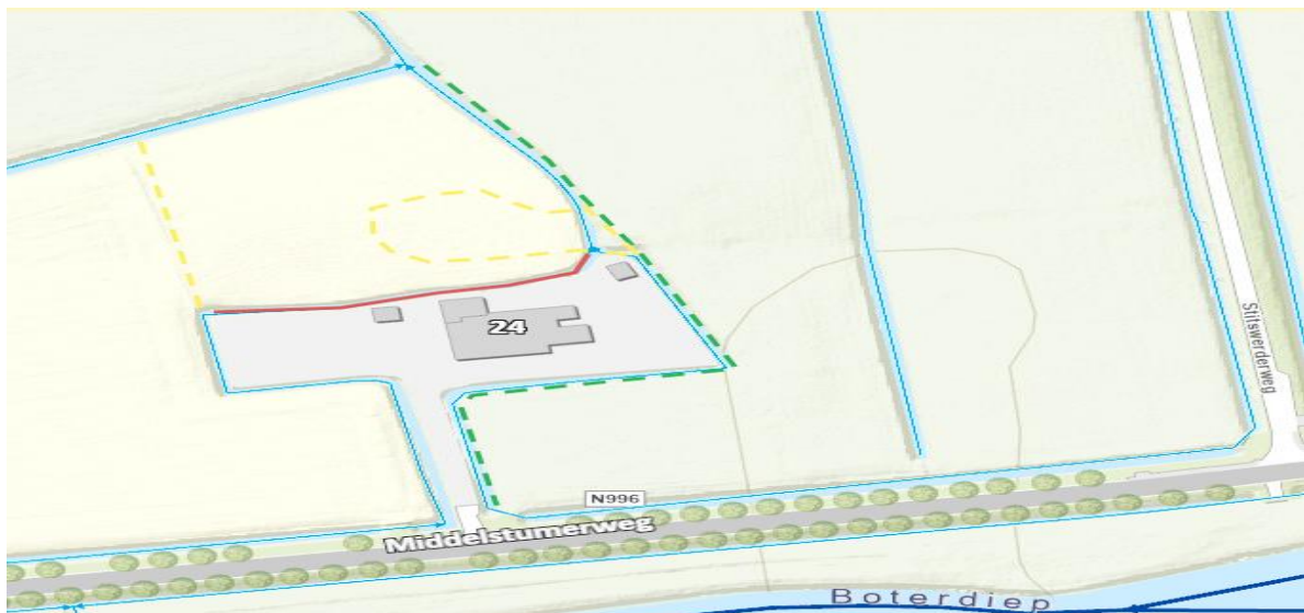
Figuur 1: Te dempen watergang weergegeven met rode lijn, te verleggen/verbreden watergangen weergegeven met groene stippellijn, nieuwe watergangen (kavelsloot en vijverpartij) weergegeven met gele stippellijnen.
