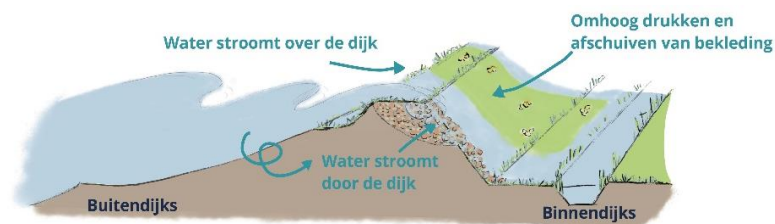
Figuur 3-3 Weergave faalmechanisme afschuiven binnendijks
