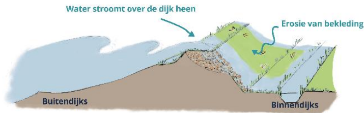
Figuur 3-1 Weergave faalmechanisme hoogte
