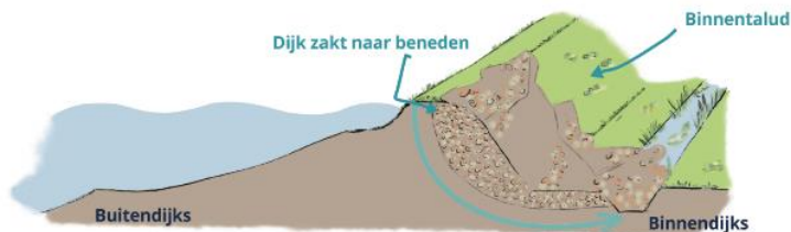
Figuur 3-2 Weergave faalmechanisme stabiliteit binnendijks
