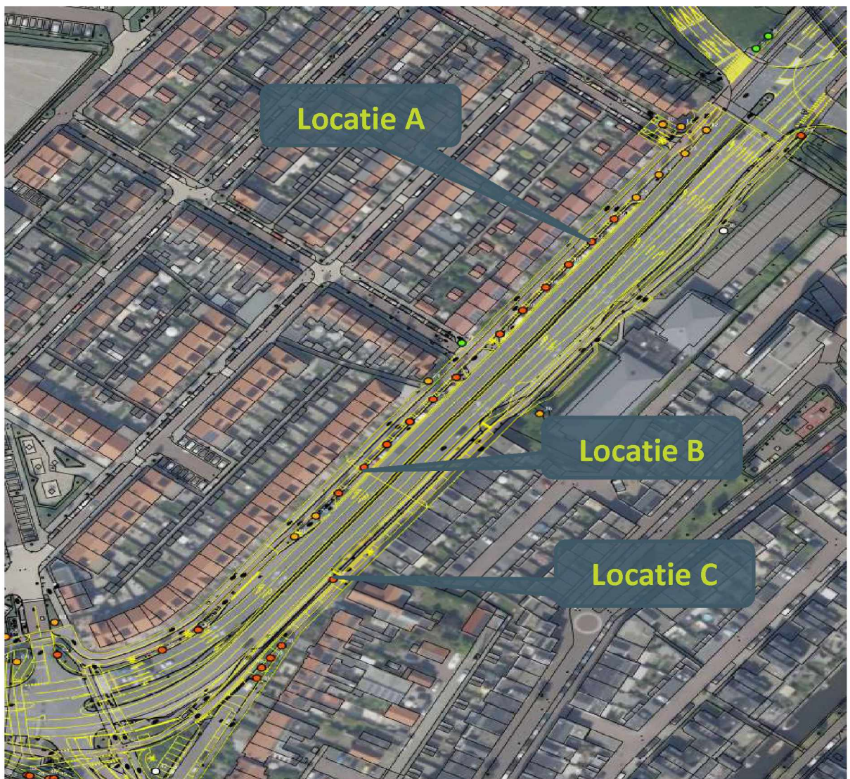
Figuur 2: Weergave van het ontwerp, boomposities en bodemonderzoeklocaties binnen het projectgebied. Positie B en C betreffen een proefsleuf in combinatie met boringen. Positie A betreft enkel een profielsleuf.
