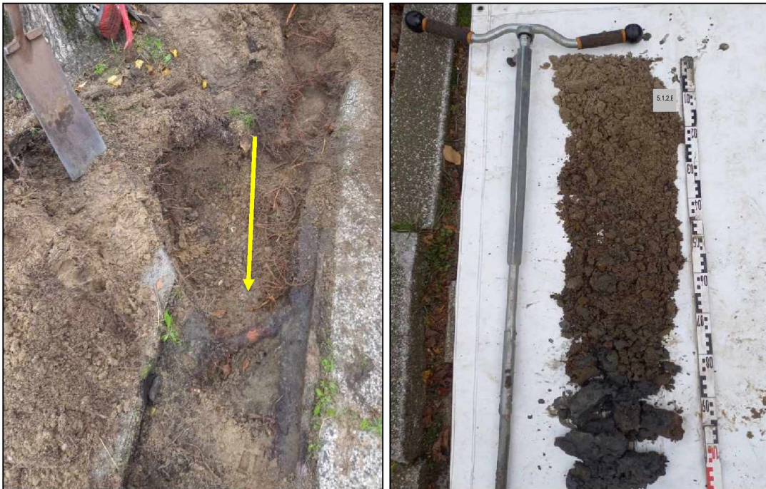
Foto 6 links: Detail van de profielsleuf op locatie B oppervlakkige beworteling.
