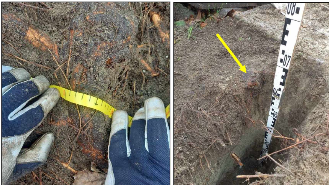
Foto 4 links: Detail van de profielsleuf op locatie A van met oppervlakkige beworteling van Ø 6 cm.
