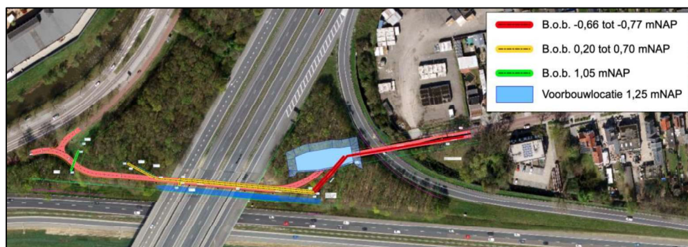
Figuur 2 – Projectlocatie met diepte onderkant constructie in NAP.
