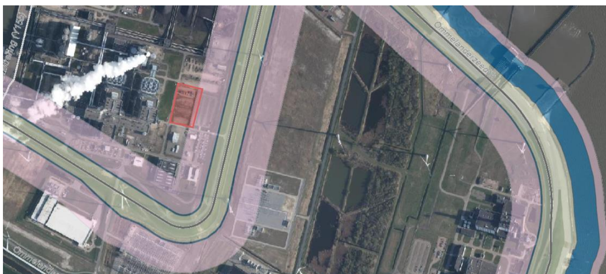
Figuur 1: In het rode vlak globaal de locatie van de beoogde waterstoffabriek, deels gelegen in het roze weergegeven beperkingengebied III van de primaire waterkering.
