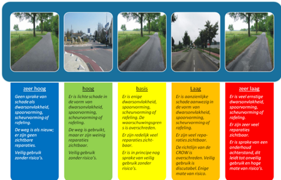
Figuur 3.2 Meetlat asfaltverharding
