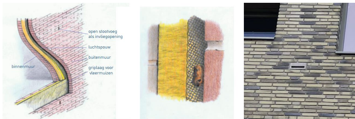
Afbeelding 7: Voorziening voor vleermuizen in de spouwmuur met entreestenen (bron: vleermuis.net en unitura.nl). In plaats van open stootvoegen (linker afbeelding) worden entreestenen toegepast (rechter afbeelding).
