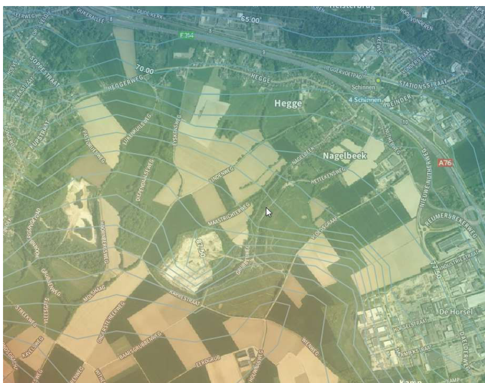
Figuur 4-3 Isohypsen LHM (Landelijk Hydrologisch Model). Alleen gebruikt ter indicatie gradiënt en stromingsrichting grondwater.
