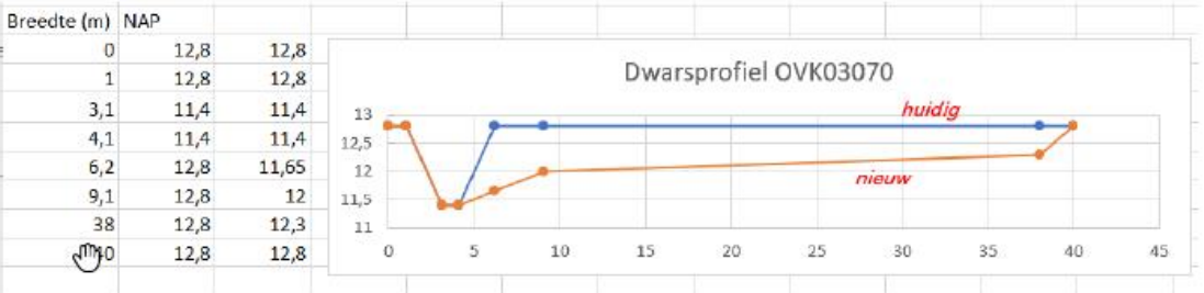
Afbeelding 4; Dwarsdoorsnede, indicatief huidig talud en nieuwe natuurvriendelijke oever.
