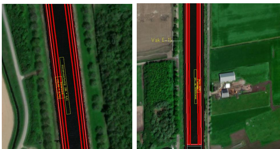
Figuur 1: Situatie met baggerwerkzaamheden met ponton aan buitenzijde (vrij ruimte vaargeul: halve vaargeul)
