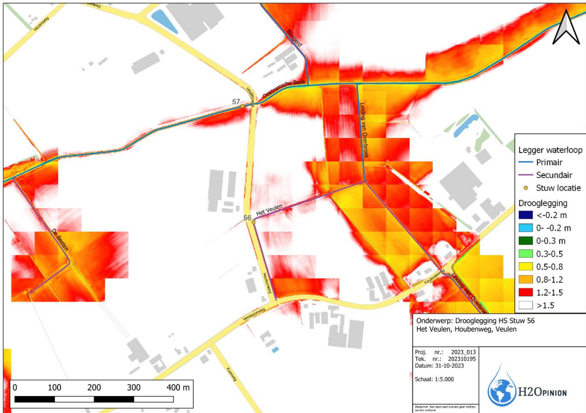
Figuur 5: Drooglegging in de situatie voor plaatsing stuw
