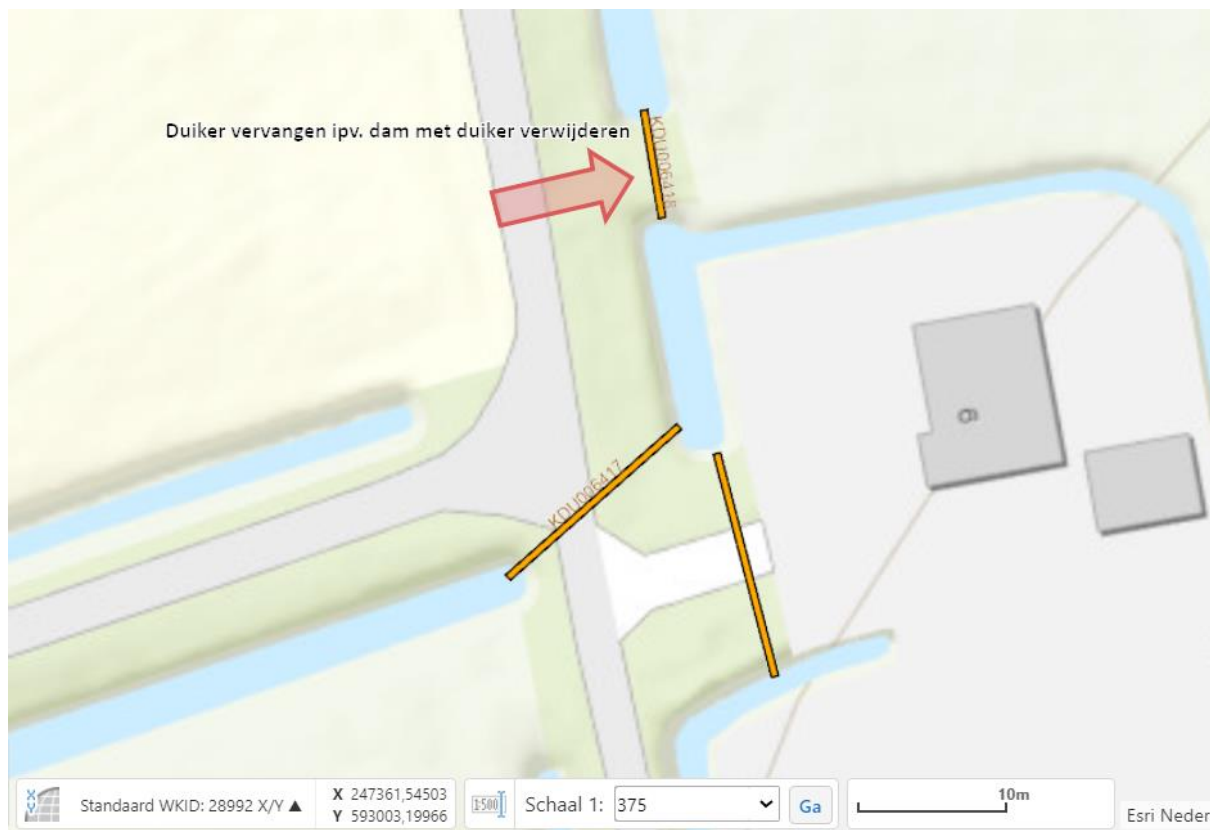
Figuur 1: De te vervangen duiker wordt aangegeven met de rode pijl;
