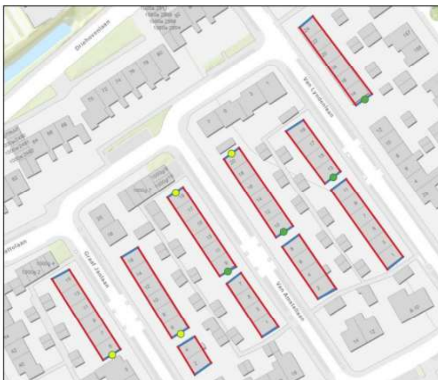
Figuur 6.1 Locaties maatwerkvoorzieningen aan kopgevels voor vleermuizen en gierzwaluw (blauwe contouren), inmetsele-kraamkasten en/of gevelbetimmering voor gewone dwergvleermuis (groene punten) en kleine inmetselekasten voor dwergvleermuizen (gele punten). Bron achtergrond: PDOOK.
