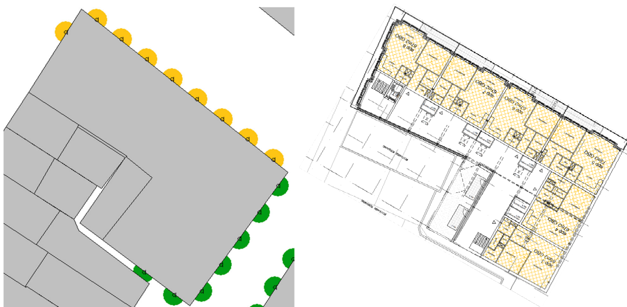
Figuur 5.1: Overzicht geluidluwe gevels in groen aangeduid (links) en plattegrondindeling conform SO-ontwerp (rechts)
