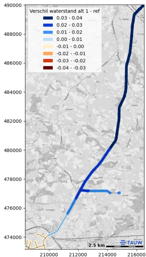
Figuur 4.1 Het effect van alternatief 1 het baggeren tot 15 cm boven de vaste bodem en het verhogen van het aanvoerdebiet met 10% (ten opzichte van 2018: 4,75 m 3 /s) op het waterpeil
