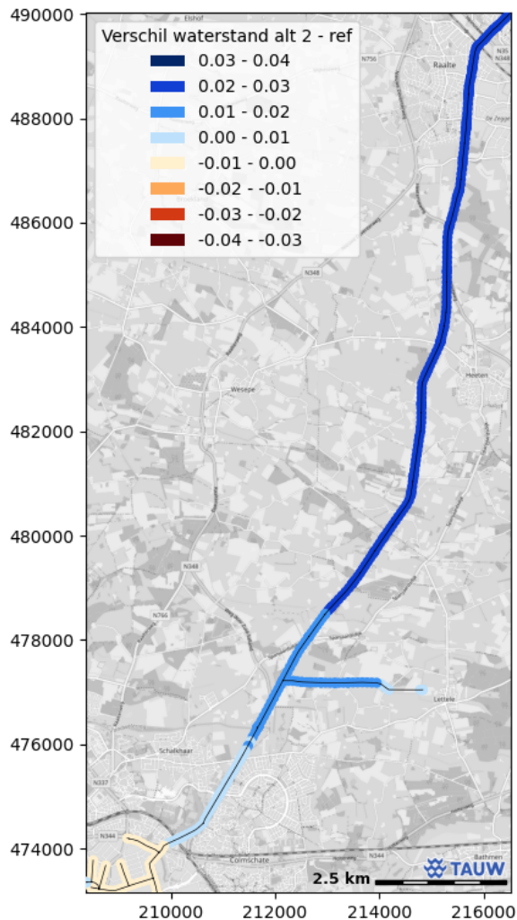
Figuur 4.3 Het effect van alternatief 2 op het waterpeil waarbij naast een 10 % hoger aanvoerdebiet en het baggeren tot 15 cm boven de vaste bodem ook het effect van de natuurvriendelijke oevers is meegenomen met een ruwheid van Manningwaarde 1
