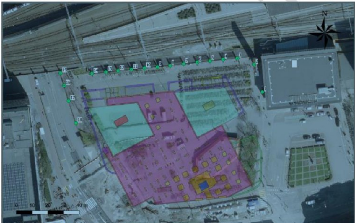
Figuur 18. Locatie deformatiebouten.
