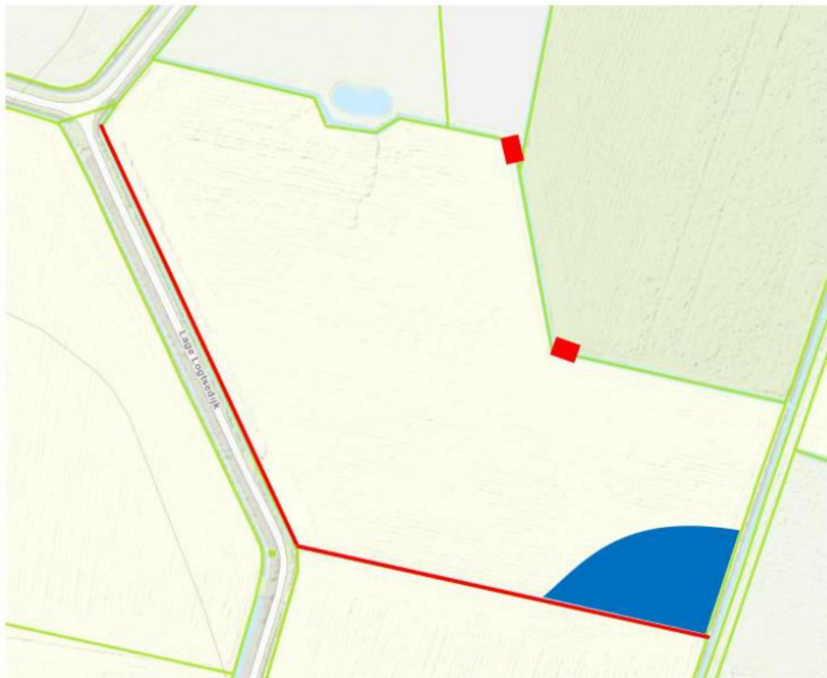
Figuur 2 – projectgebied De Logt Oisterwijk met de te dempen sloten (rode lijn), de af te graven laagte (blauw) en de te verwijderen dammen met duikers.
