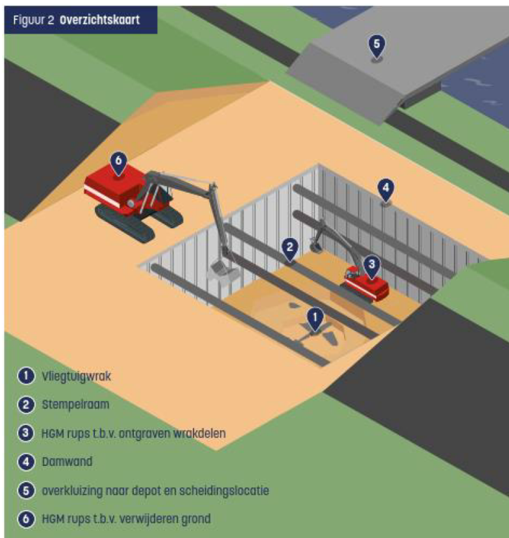
Figuur 3: Schematische weergave bouwput Vickers Wellington te Holwerd [13]
