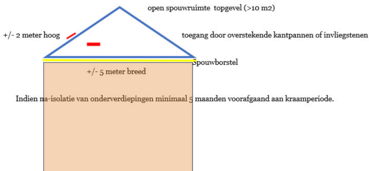
Figuur 2 Voorbeeld open spouwruimte topgevel (Bron: provincie Gelderland).
