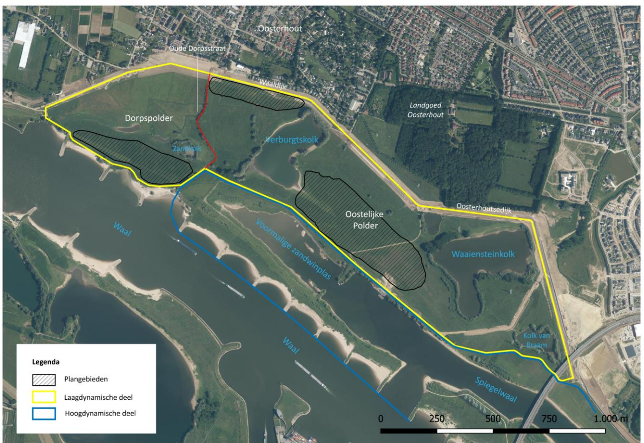
Figuur 2. Luchtfoto van de percelen waar de ontwikkeling van riviernatuur door kleiwinning 'Dorpspolder' (geel) en zand afgraven beoogd is 'Oostelijke Polder' (rood), bron: Google Earth (2020).
