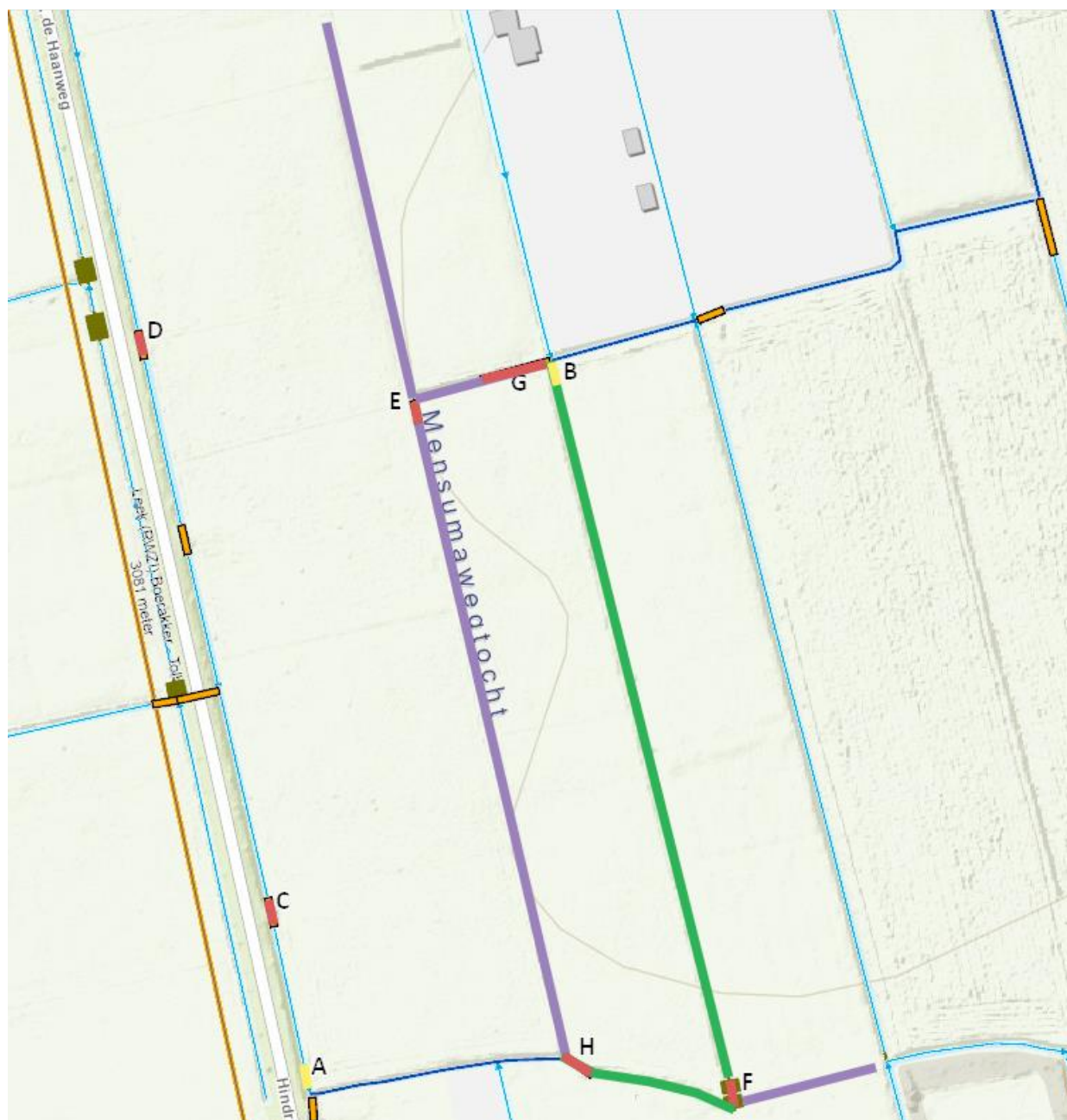
Figuur 1: Overzicht van de werkzaamheden, waarin met geel de aan te leggen dammen met duiker (A en B) zijn weergegeven, met rood de te verwijderen dammen (met duiker) (C, D, E, F, G en H), met groen de te vergroten en aan te wijzen primaire watergang zijn weergegeven en met paars de te dempen en gedempte watergangen.
