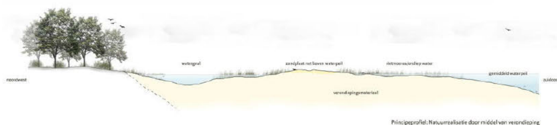
Figuur 4.1 Inrichtingsschets plas Goorsche Veld met principe dwarsprofiel
