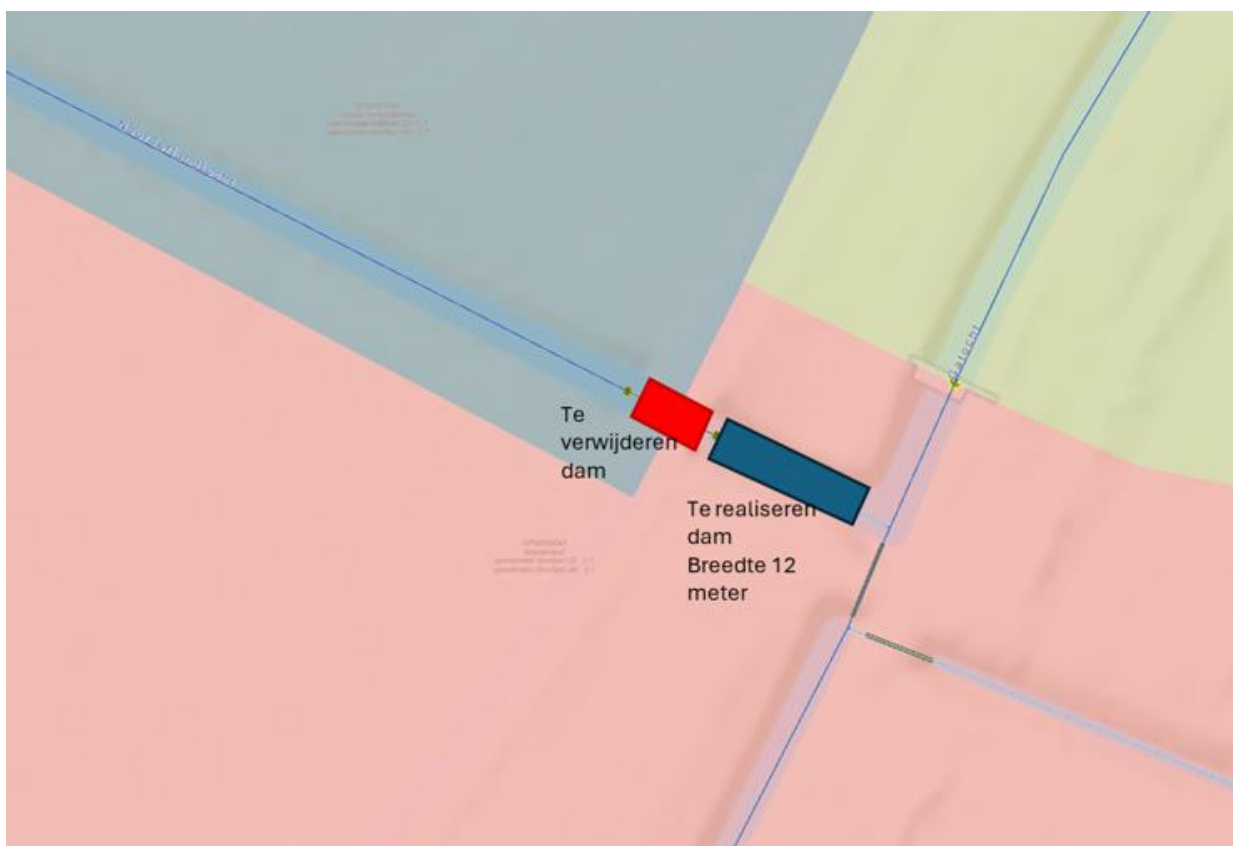
Figuur 1: Overzichtstekening van de werkzaamheden.
