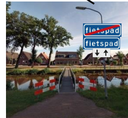
Plaatsen G13 en G14 bord + onderbord OB505 nabij de brug – beide kanten; Markeweg / Westerstraat (conform RVV 1990) t.h.v. Markeweg 99
