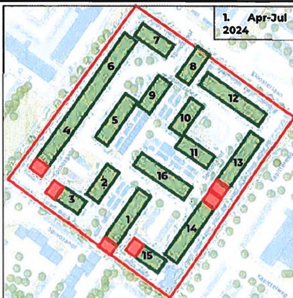
Figuur 19| Deelgebied 1.2: Spinozahof. Deelgebied omkaderd in rood. Fase 1 is in groen omkaderd, fase 2 in rood. De werkvolgorde is genummerd waarbij de werkzaamheden bij 1 starten
