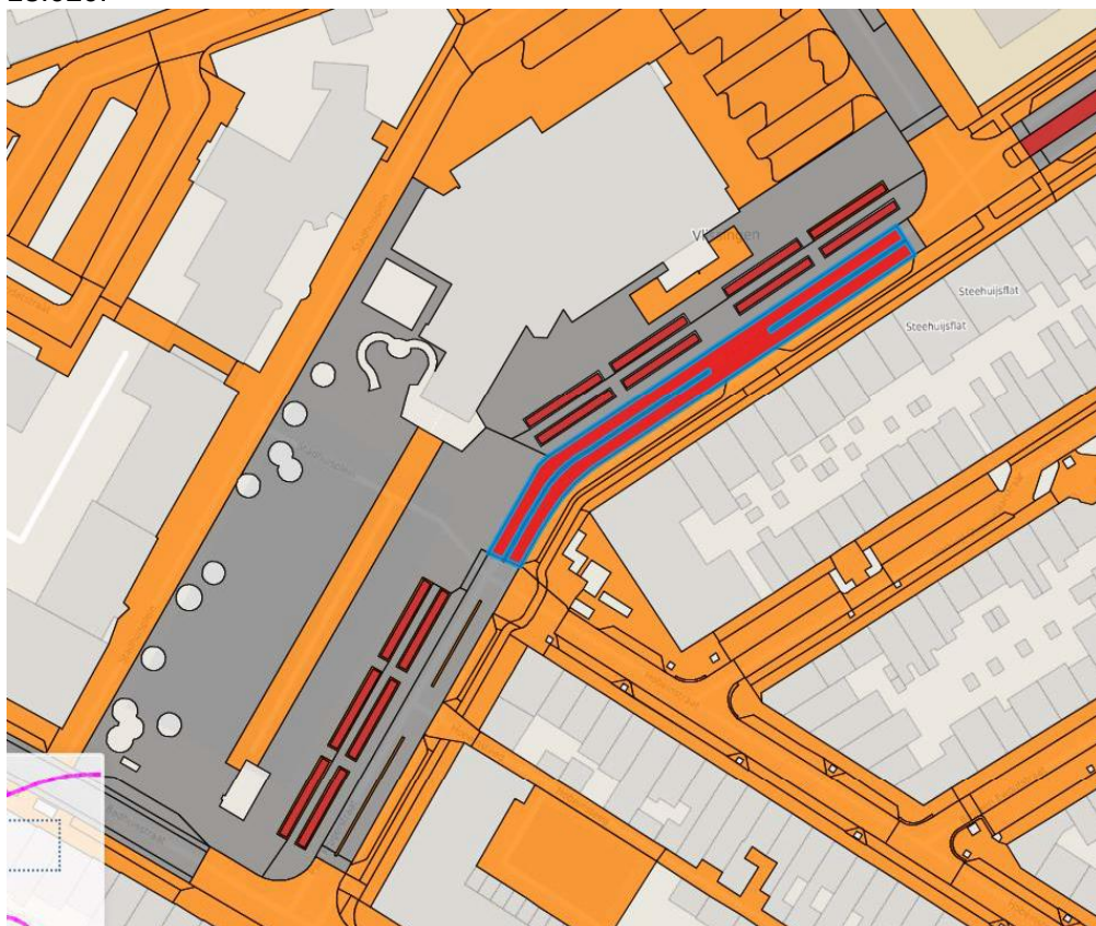
Paul Krugerstraat gedeelte Badhuisstraat – Brouwenaarstraat. Zeer Stil Asfalt / Semi Dicht (ZSA-SD) (ZSA 5 porfier Cariphalt) dik 30 mm. Aannemer KWS. Aanleg 2014. Project 13.020.
