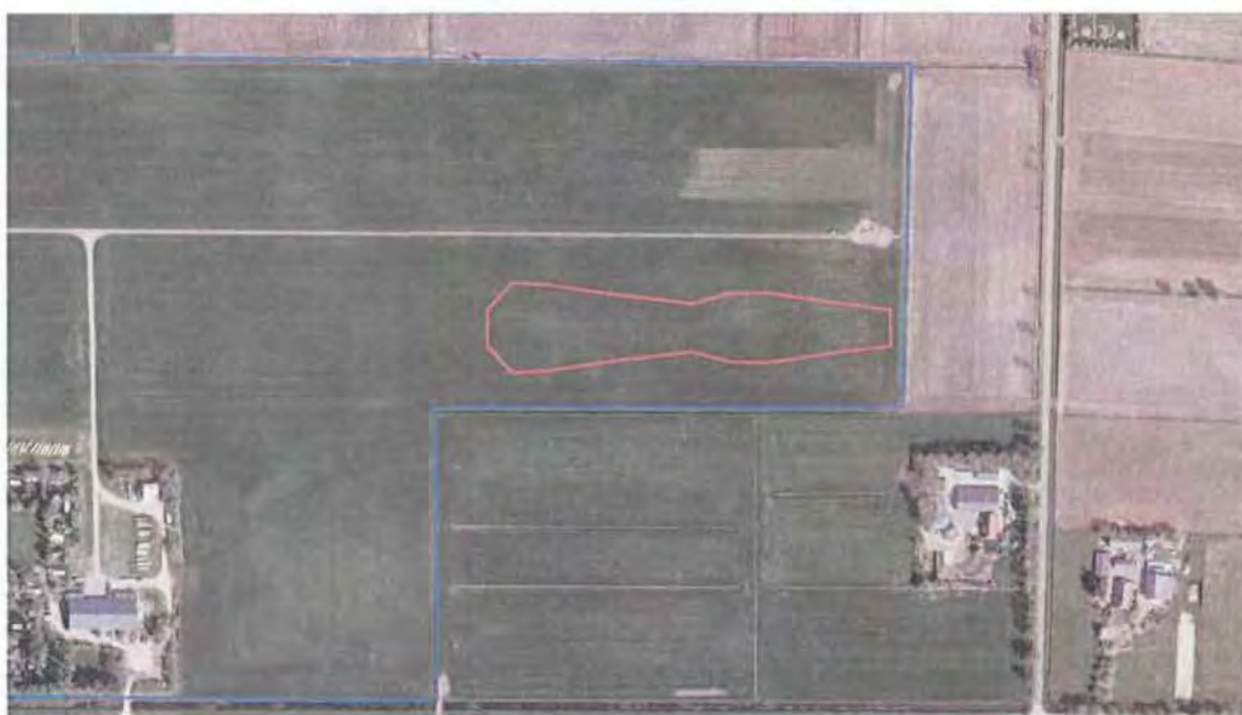
Fig.3 Plaatsgebonden risicocontouren 10^{-6} per jaar rood van het oostelijke deel van het vliegveld Lemelerveld.
