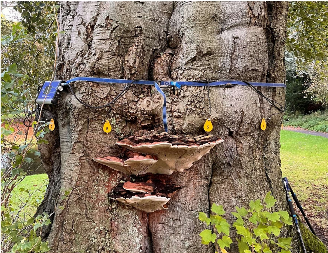
Afbeelding 3: Onderzoek met de Picus geluidstomograaf bij boom 031-42.228 ( Fagus sylvatica Atropunicea )
