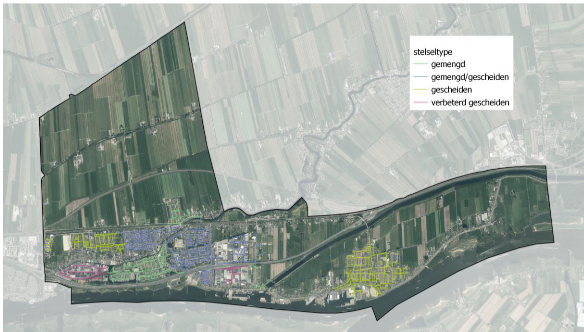
Figuur 6 Type vrijvervalstelsels Hardinxveld-Giesendam
