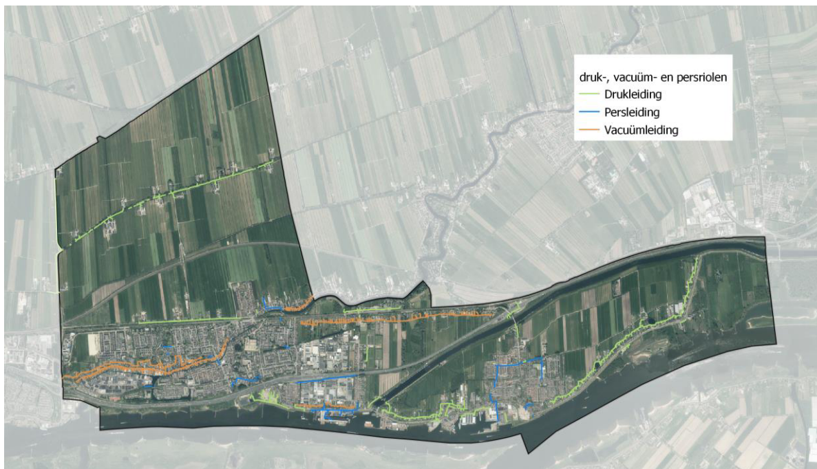
Figuur 9 type drukstelsels Hardinxveld-Giessendam
