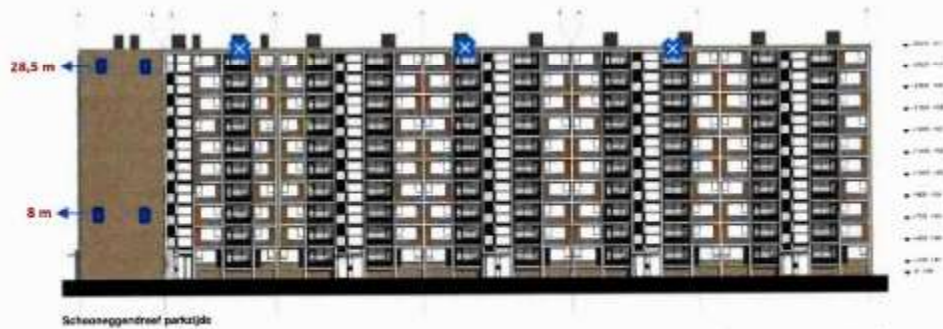
Schooneggendreef parkzijde Figuur 5.6 Locaties en hoogtes van inbouwstenen en verblijfplaatsen dakrand op gevels Schooneggendreef Parkzijde. (bron: Door Architecten, 2022)
