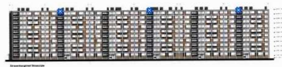
Stroyenborchdreef Straatzijde Figuur 5.8 Locaties en hoogtes van inbouwstenen en verblijfplaatsen dakrand op gevels Stroyenborchdreef Straatzijde. (bron: Door Architecten, 2022)
