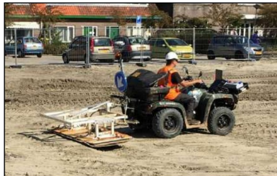
De 3D grondradar achter een quad
