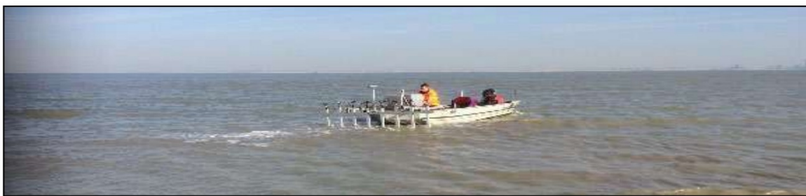
Uitvoeren passieve NON realtime waterbodemdetectie m.b.v. detectieboot.
