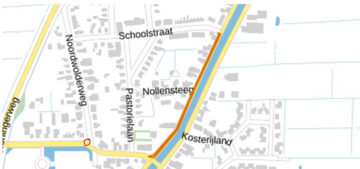
Figuur 1: In het oranje het deel van het tracé waarvoor de vergunning geldt. Ter plaatse van de rode cirkel wordt een duiker gekruist. Dit is vergunningsvrij. Er geldt wel een voorschrift. Dat is in de aanbiedingsbrief opgenomen.
