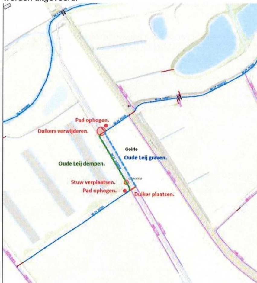
Figuur 2. Overzichtskartaal van werkzaamheden
