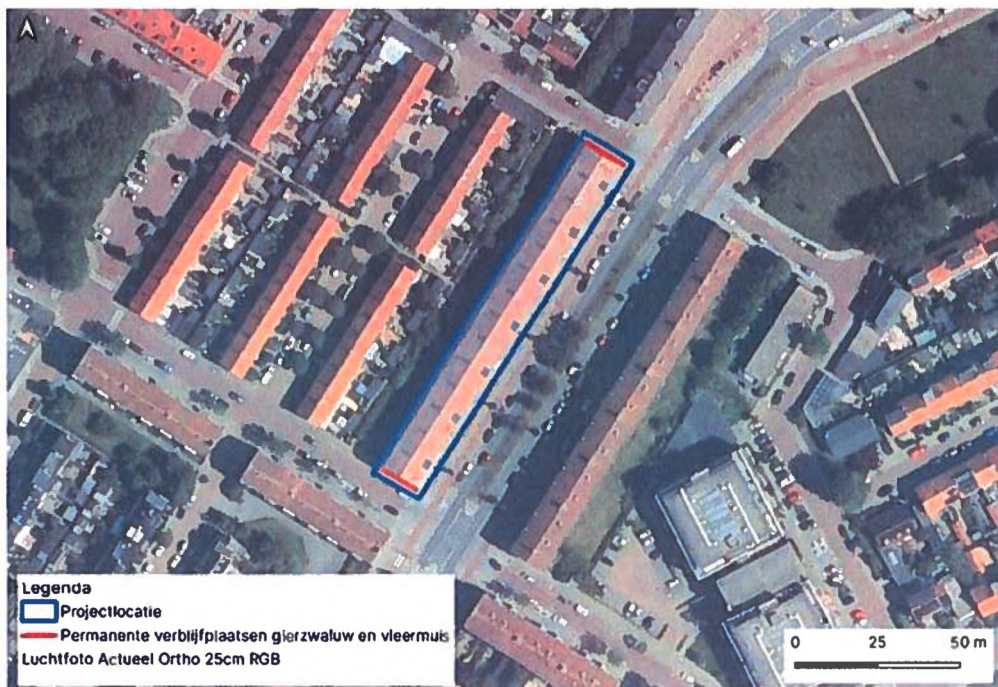
Figuur 1. Locaties van de permanente alternatieve verblijfplaatsen in het plangebied in de vorm van gevelbetimmeringen met dertig nestlocaties voor de gierzwaluw en acht ingebouwde vleermuiskasten voor de gewone dwergvleermuis.
