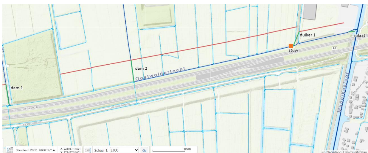
Figuur 1: De groene lijnen geven globaal de locaties weer van de aan te leggen duikers en de aan te leggen inlaat. De oranje stip geeft globaal de locatie weer van de aan te leggen stuw.
