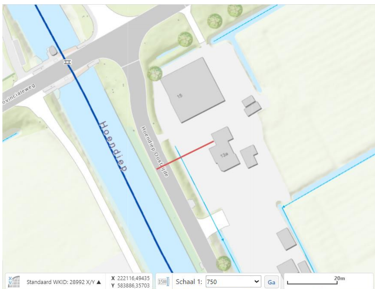
Figuur 1: De rode lijn geeft globaal de locatie weer van de aan te leggen kabel.
