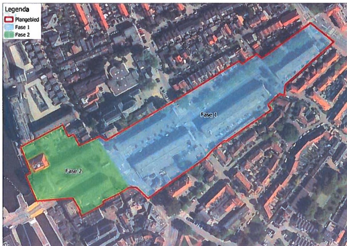
Figuur 1: plangebied (bron luchtfoto: PDOK, 2022). Het plangebied is opgedeeld in twee fasen, waarbij de bebouwing in fase 1 als eerste gesloopt zal worden.
