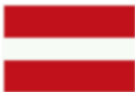
Bord A.1, In- uit- of doorvaren verboden
