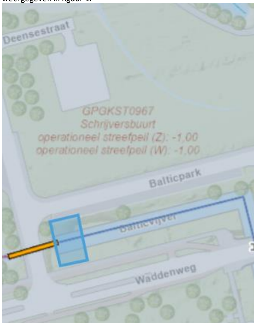
Figuur 1: De locatie van de tijdelijke demping en duikerverlenging in de Nieuwe Boerdpstertocht is weergegeven met het blauwe vlak. De te verlengen ronde betonnen wegduiker (van 500 mm doorsnede) is weergegeven in oranje.
