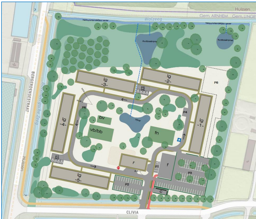
Figuur 14. Principetekening ligging van de afvoerleiding/landbouwkundige afvoerleiding. Bron: Looije Agro Technics BV.
