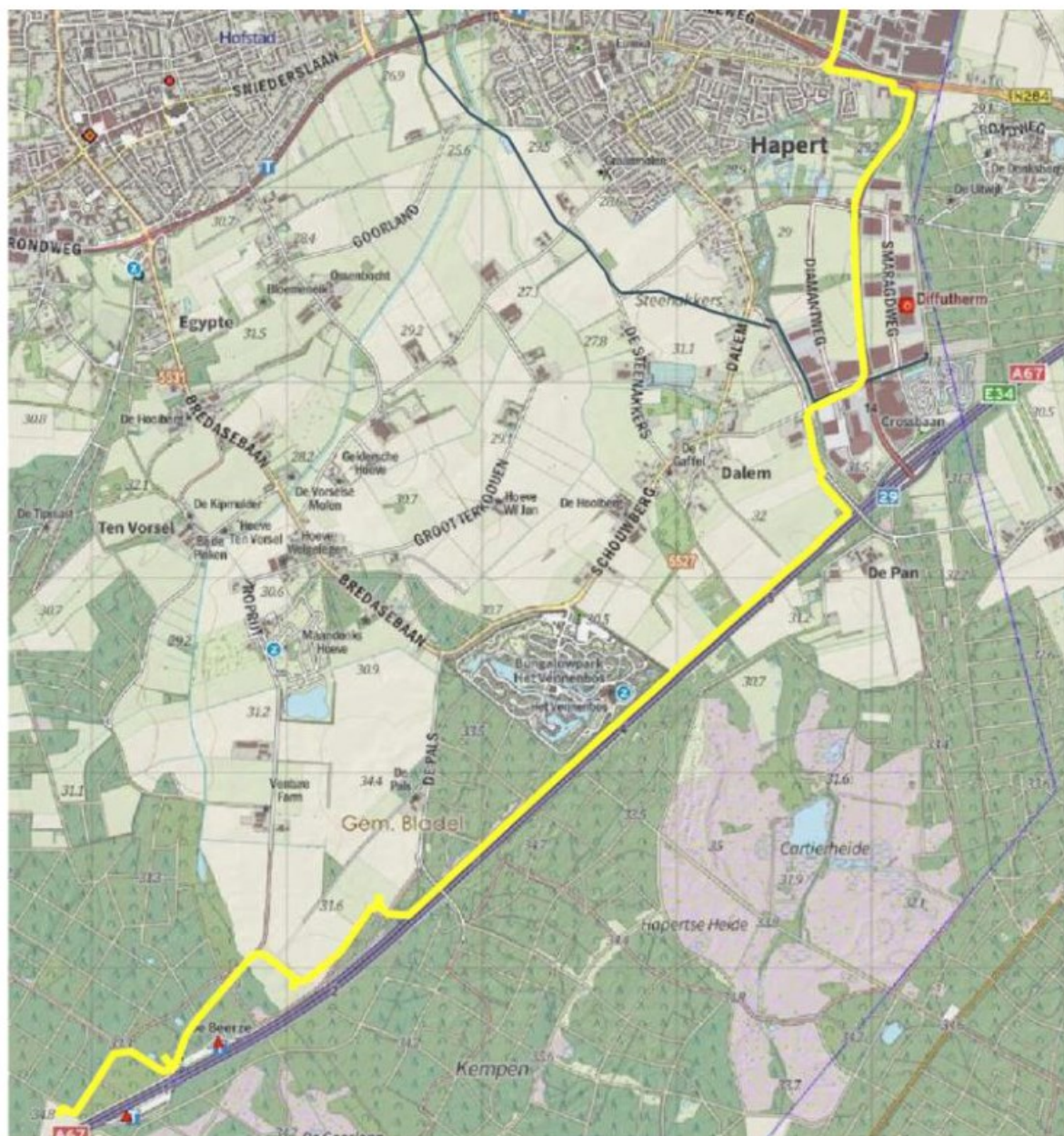
Figuur 2 Kabeltracé windpark de Pals
