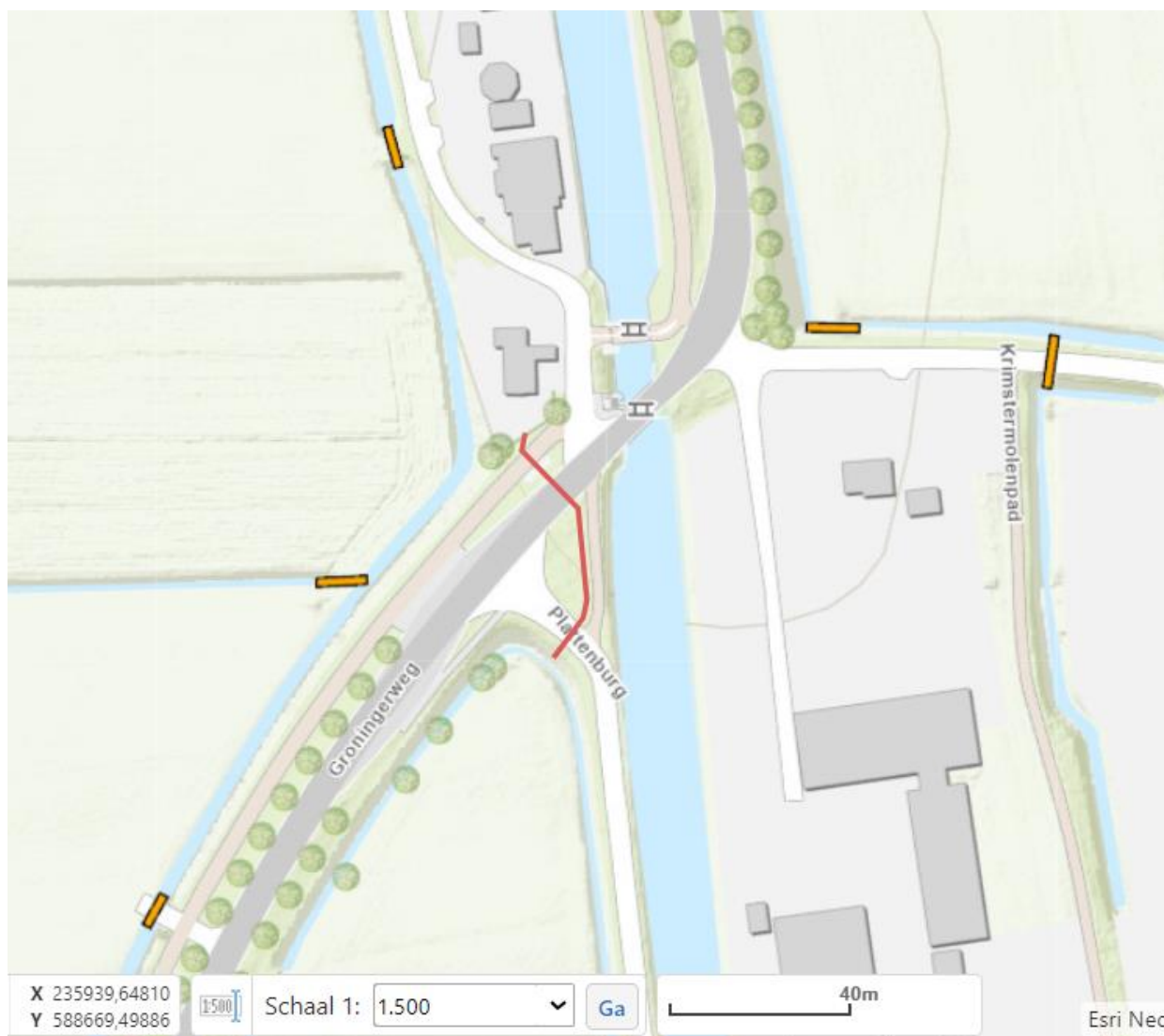
Figuur 1: De rode lijn geeft globaal de locatie weer van de aan te leggen waterleiding.
