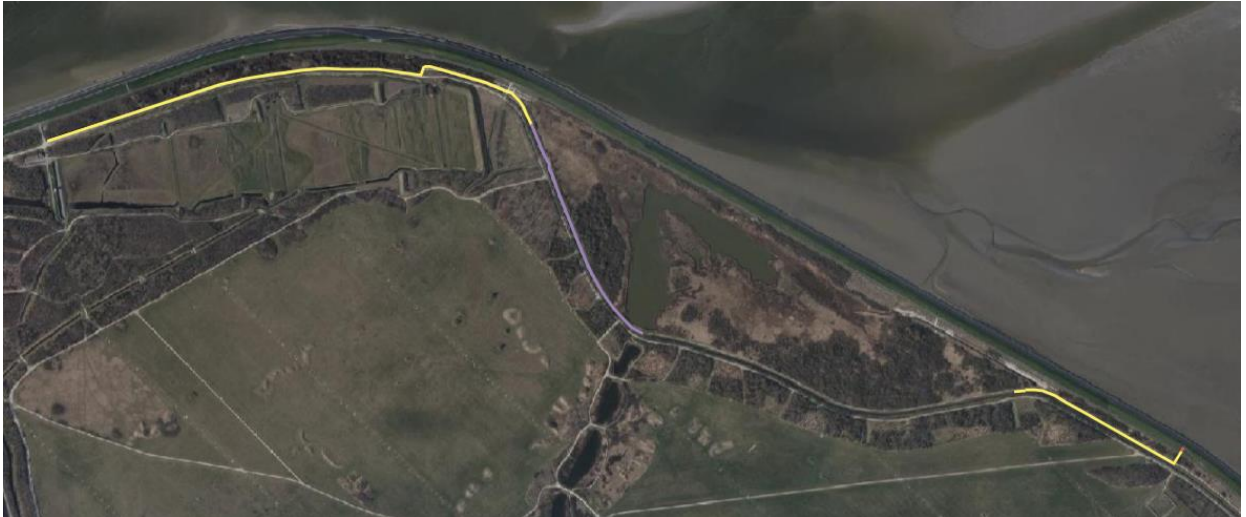
Figuur 1: In het geel, paars en rood het beoogde kabeltracé, waarbij: Rood = tracé gelegen in beperkingengebied I van een primaire waterkering (helemaal rechts, in het dijktaalud); Geel = tracé gelegen in beperkingengebied I en II van een primaire waterkering; Paars = tracé waarvoor geen melding of vergunning is vereist.
