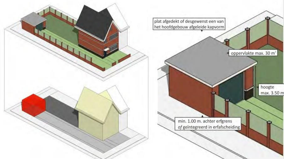
losstaand bouwwerk: bijgebouw hoekwoning
