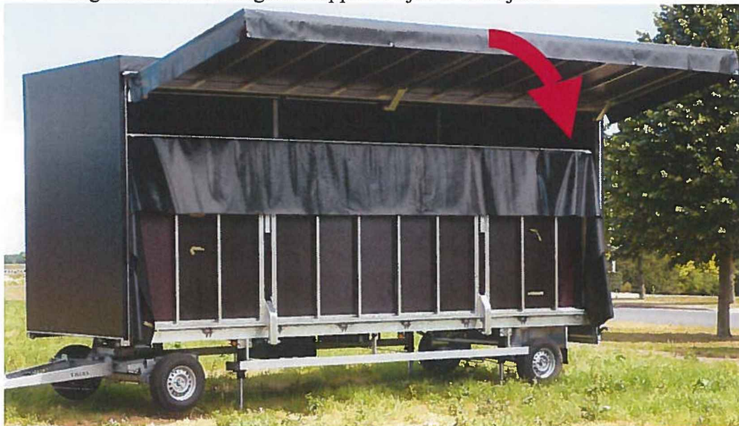
Figuur 11: Knop 4 afstandbediening is luifel dicht
