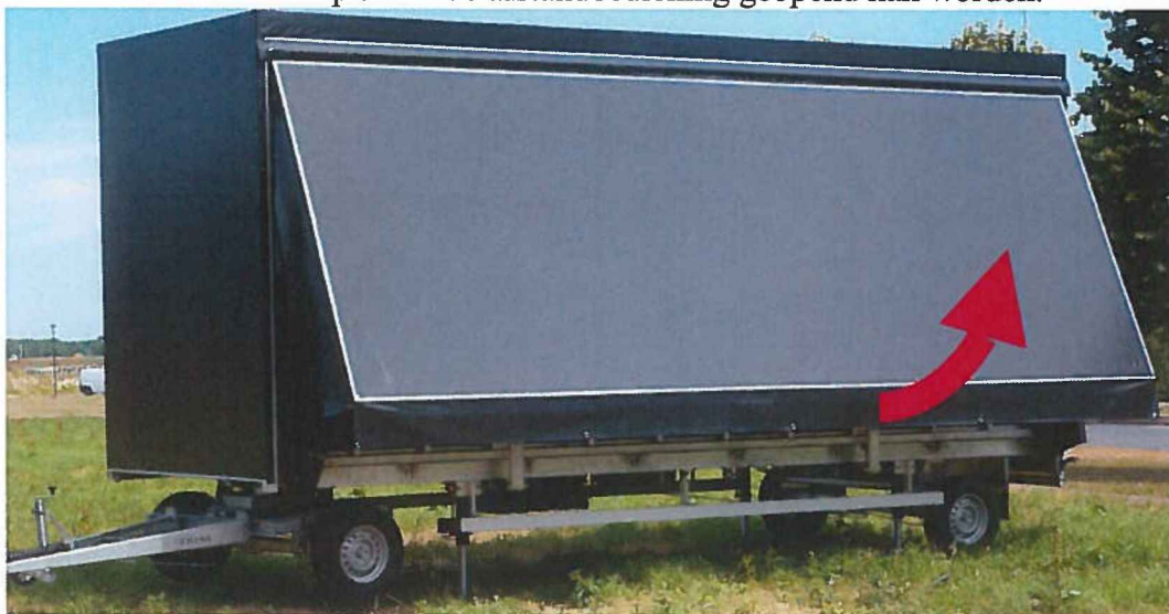
Figuur 7: Knop 3 afstandbediening is luifel openen
