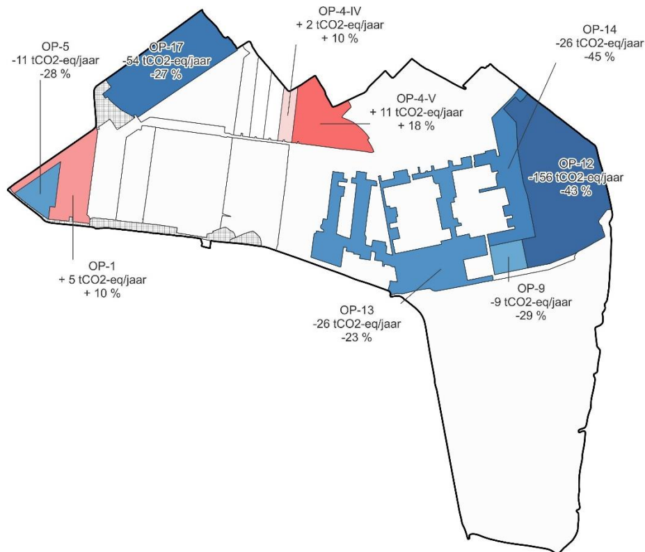
Figuur 30: Verschil in broeikasgasemissies tussen het scenario met het ontwerp peilbesluit en de huidige situatie.
