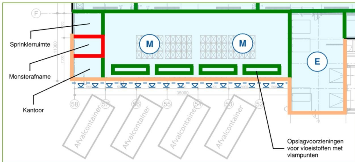
Figuur 1 Brandwerende maatregelen Hal M (groen= 60 min. | rood= 120 min. | oranje= niet brandbaar)
