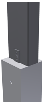
Afbeelding 1 Detail binnenkolom met strip
